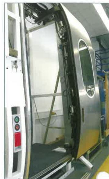
Funktionstest einer druckdichten, pneumatisch angetriebenen Außenschwenschiebetür mit Klapptritt
