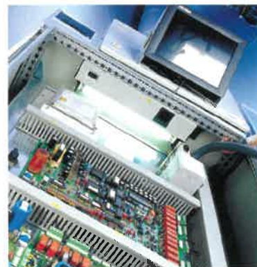
Abb. 1: Steuerungsplatinen mit RT Relais
