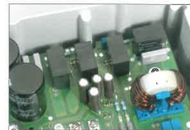
Abb. 3: PCFN Solar Relais mit 1,5 mm Kontaktabstand
