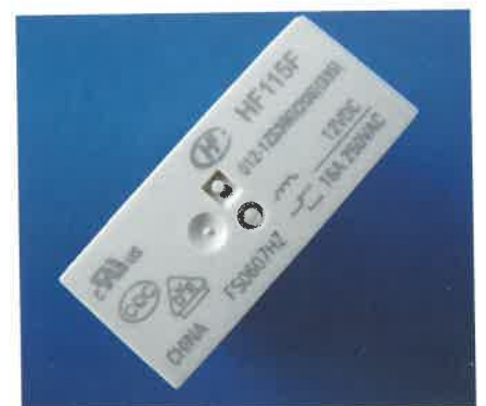
Abb. 3 Elementarrelais mit offenem Belüftungsloch an der Oberseite
